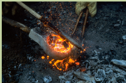
Die bei Temperaturen knapp unterhalb von 1000°C geschmolzene Bronze wird in die Gussform gefüllt.
