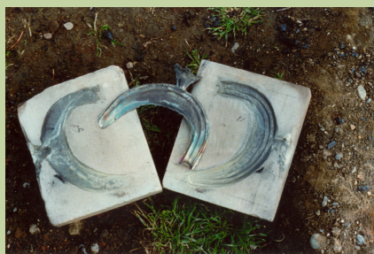
Das Gussstück wird aus der Form geholt und nachbearbeitet.
